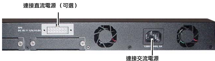
圖 1-15. 交換器的交流和直流電源連接
